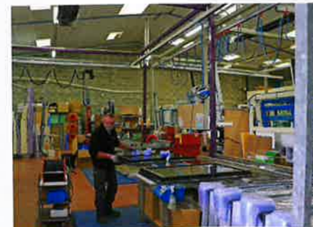
Le pôle vitrage (réorganisé en 2021). La zone dédiée au vitrage à plat des cadres alu a été équipée de deux palonniers fin 2019.
