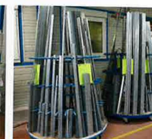
Des renforts acier débités.
