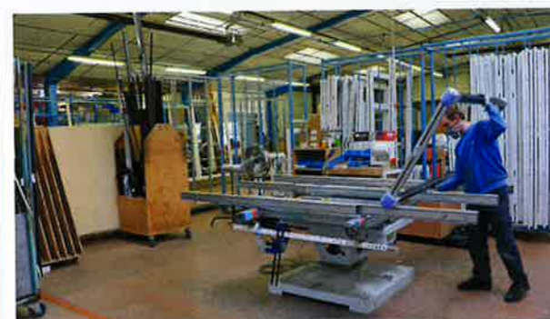
Pose de profils périphériques sur le dormant et vérification de la menuiserie. Outre l'autocontrôle tout au long du process, un contrôle quotidien d'une menuiserie complète est effectué au niveau de la zone de vitrage.
