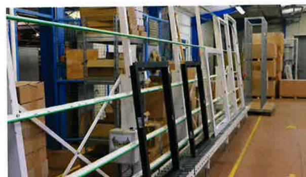
Les dormants sont dirigés vers d'autres postes de ferrage, différenciés selon le matériau.
