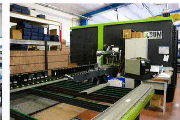
Les profils sont étiquetés manuellement à la sortie.
