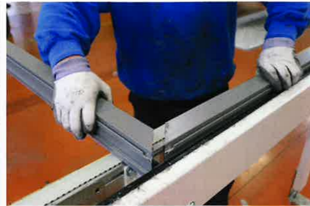
Les grands cadres sont assemblés directement sur la sertisseuse.
