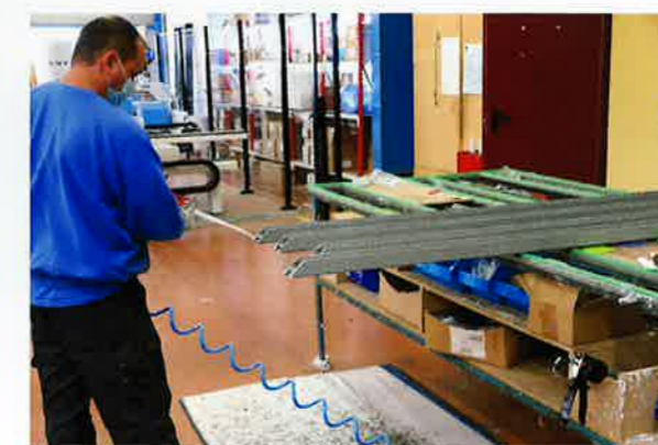
Fabrication des cadres : les angles sont étanchés au mastic.
