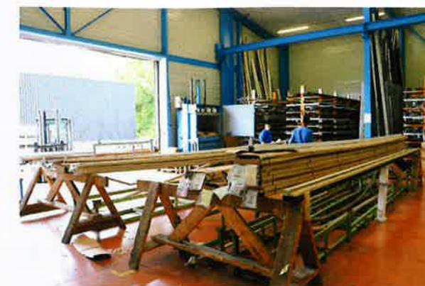
Les barres de 6,5 m sont livrées en civières ou en cartons pour les petites séries. Elles sont déballées et contrôlées.
