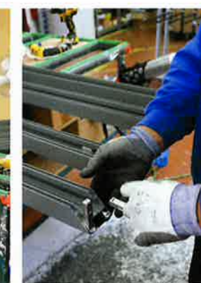
Ils sont assemblés mécaniquement, à l'aide d'équerres et de colle.
