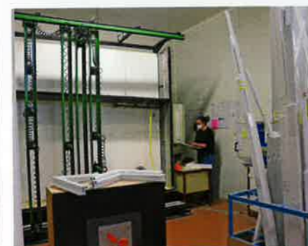
Le caisson d'essai sert aussi pour les tests AEV, alternés sur des cadres alu et PVC chaque semaine.
