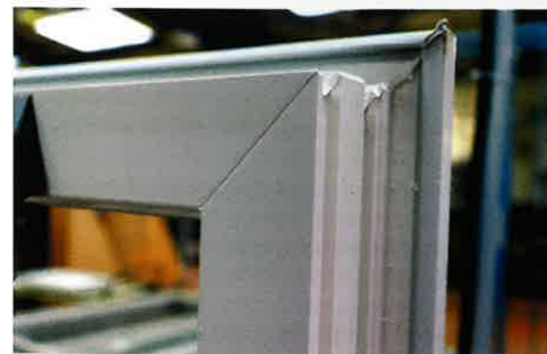
Grâce à la soudeuse-ébavureuse, la finition obtenue sur les cadres PVC est identique à celle des menuiseries alu.
