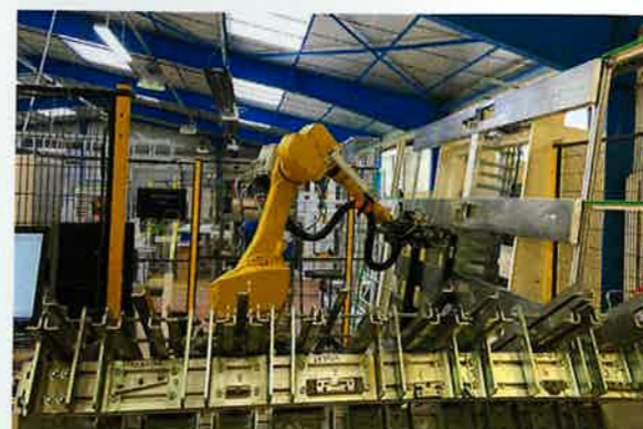
Ce robot de ferrage, en fonction, depuis dix ans traite aussi bien les dormants alu que PVC.
