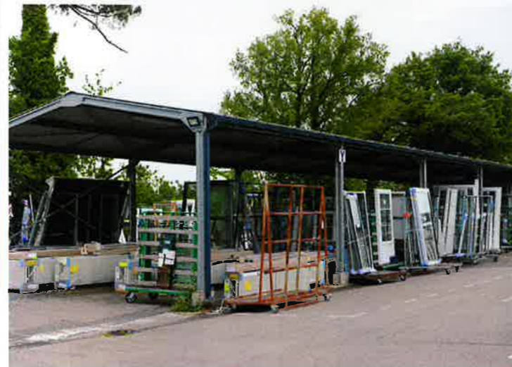
Zone de stockage des menuiseries finies (une case par agence). Chaque agence est livrée une à deux fois par semaine (les produits posés localement sont retirés directement par les équipes de pose).
