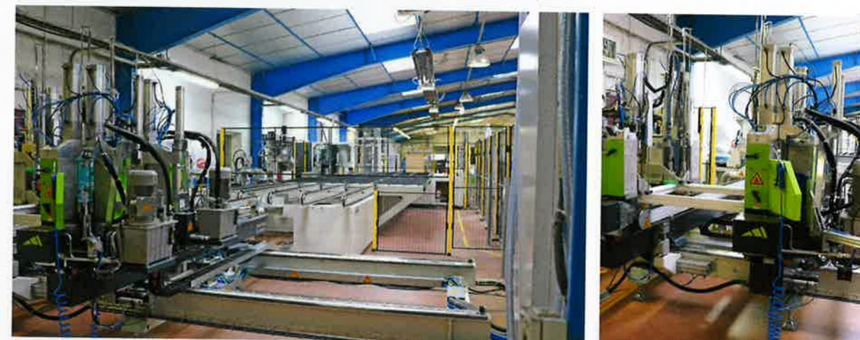
Zoom sur la nouvelle soudeuse Weld'On sans ébavurage sur les faces visibles DGM KMW, utilisée depuis le printemps dernier pour la fabrication des cadres de dormants et ouvrants.
