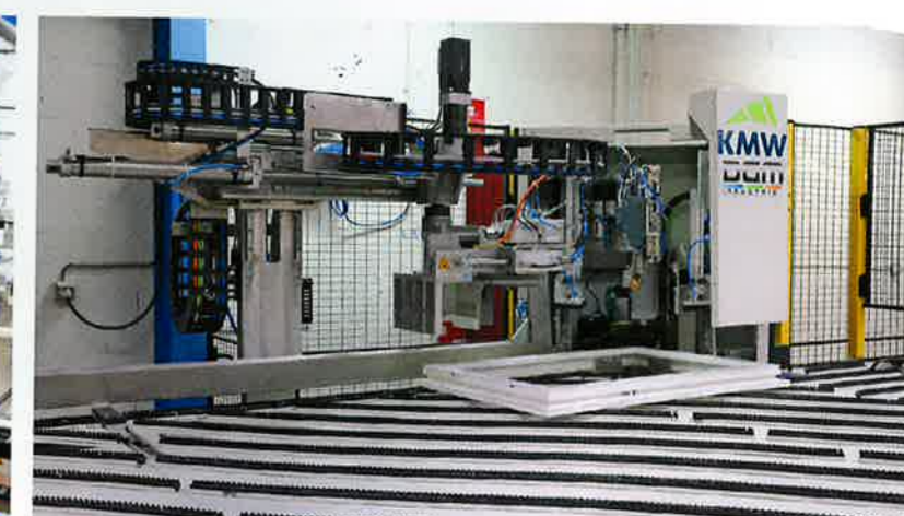
Après la soudure des angles (à 250 degrés), des groupes hydrauliques coupent les cordons avant refroidissement, ce qui apporte des deux côtés du cadre un niveau de finition proche de celui obtenu sur les cadres aluminium, une rainure très discrète.
