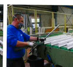
Elles sont renforcées manuellement, quand c'est nécessaire.
