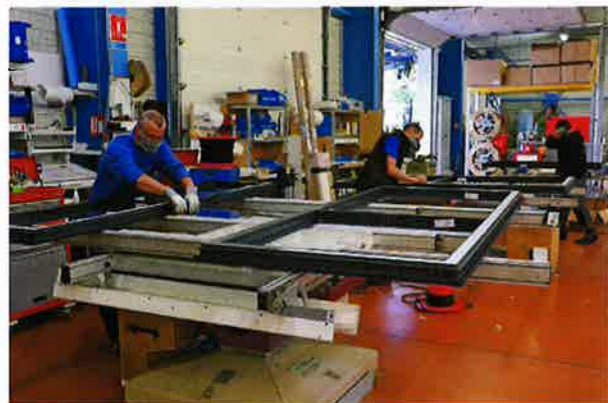
Pose des joints, parcloles, quincailleries, serrures.
