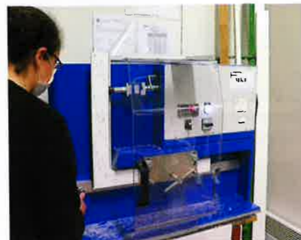
Une personne dédiée réalise ces tests de résistance tous les matins. Un minimum de 60 Pascals est requis pour chaque angle.
