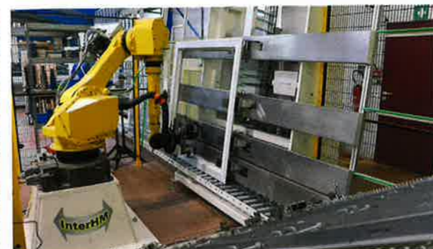
Lignes des dormants : ce robot de ferrage pose lui aussi la quincaillerie indifféremment sur l'alu et le PVC. Selon les instructions lues sur le code barre de l'article, il s'équipe du porte embout adéquat et pioche dans son magasin les pièces à fixer.
