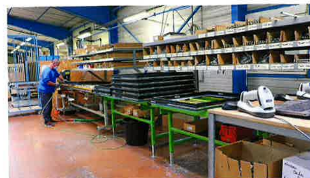
Ligne des ouvrants : la quincaillerie est la même sur les fenêtres en PVC et en alu. Ici, pose de quincaillerie sur un ouvrant alu apporté du second bâtiment.
