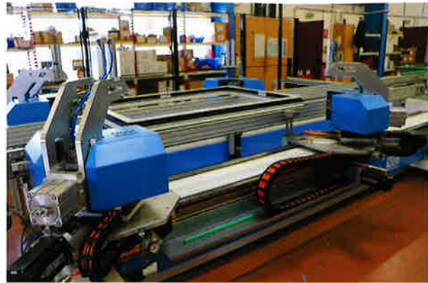
Une fois les 4 parties positionnées, la sertisseuse de fabrication DGM industries entre en action. Installée en 2020, cette machine accepte des formats jusqu'à 4100 mm x 2800 mm.
