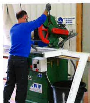
Tous les jours, un cadre est scié pour réaliser le test de casse sur les 4 angles.
