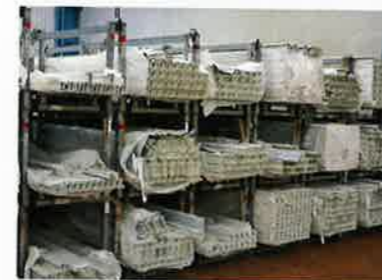
Arrivées en civières, les barres PVC Kömmerling de 6,5 m sont mises en lot.
